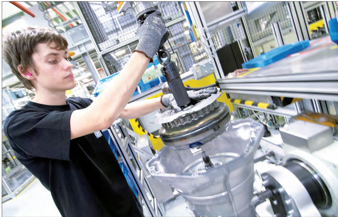
8-Gang-Automatgetriebe-Montage im Werk Saarbrücken
